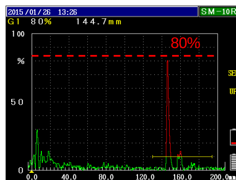
図4 溶接中心部のエコー高さ
