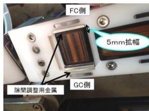
図-5 拡幅探触子の取付状態(隙間調整用金属有)
