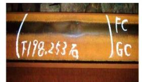
写真-3 拡幅探触子で検知したシェリング傷
