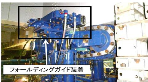
写真-2 駆動式エンドレス装置及びフォールディングガイド
