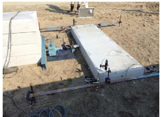
図-3 水平載荷試験装置の設置状況
