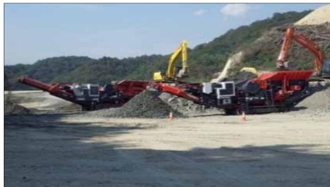
図 2 自走式破砕機による粒度調整
