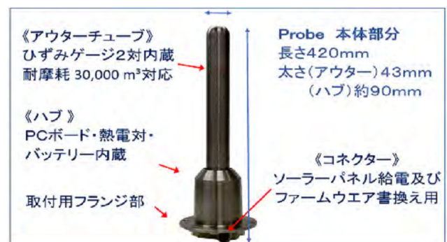
図-2 プローブの構造
