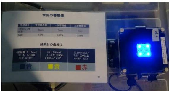
写真-4 光るデータロガーによる計測状況
