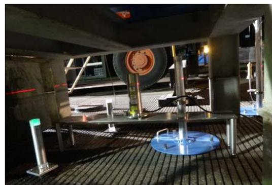
写真-3 架台下での計測状況 (中央に傾斜計設置, 左側にレーザー光)
