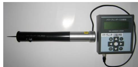
写真-2 パワーブレンダー工法硬度計
