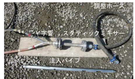
写真-1 混合部と注入パイプ
