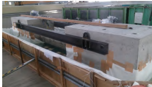
写真 3-2 通電作業状況(試験体 No.2)
