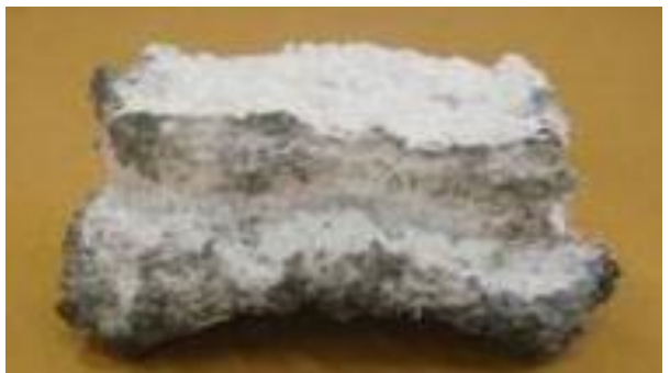
写真-6 耐火塗料（灰化完了）
