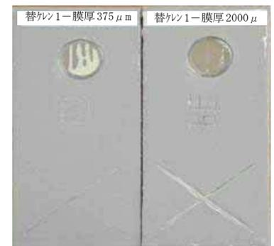
写真-3 試験体例 (防食性, 付着力試験)
