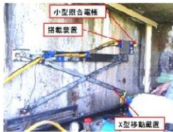
写真-3 自然電位測定 (X型移動装置搭載)
