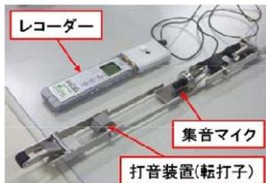
写真-4 打音点検装置
