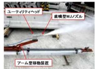
写真-1 異物除去用のWJ(ワイパー型移動装置搭載)
