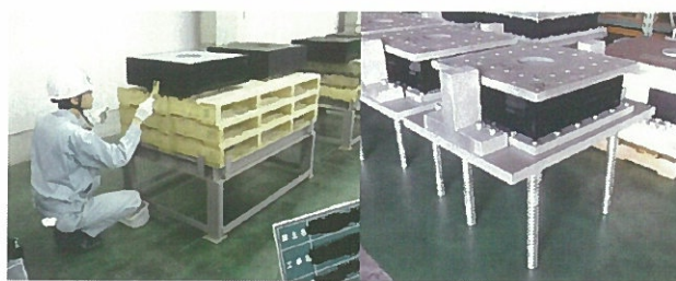
図-4 製品での K-Coat-R 施工例
