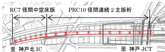
図-1 中高架橋平面図
