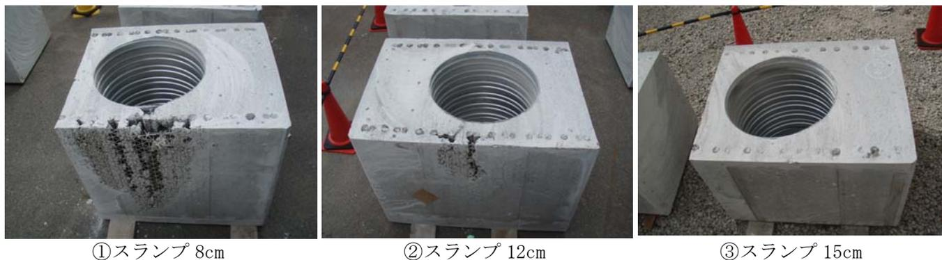
図-3 試験体の切断面及び底面の状況
