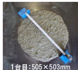
写真-1 スランプフローの確認状況
