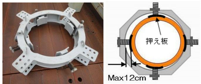
写真-2 開発したブレースリング
