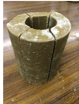
図-4 破壊の様子
