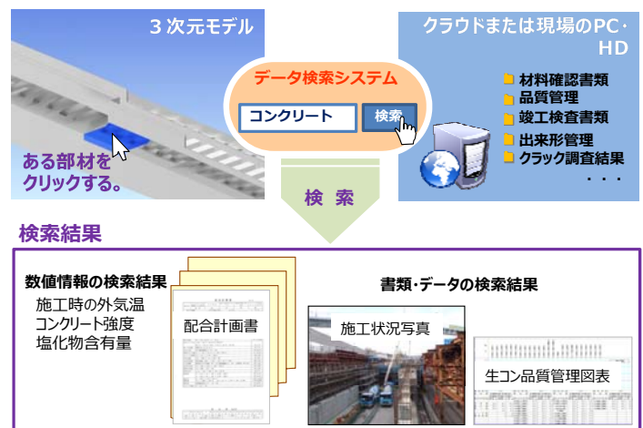
図-3 大容量データ処理技術と連携した CIM モデルのイメージ
