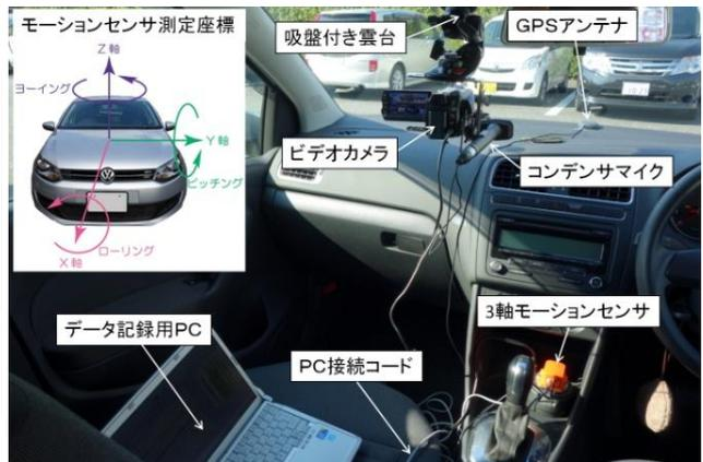
図-2 測定車両とセンサ設置状況
