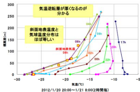
図-3 気球観測による高度と気温の関係
