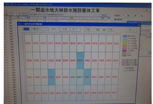
写真2 打込み管理システムのパソコン画面
