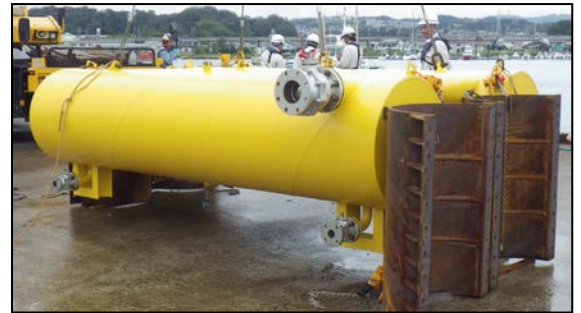
写真-1 鋼製フローター
