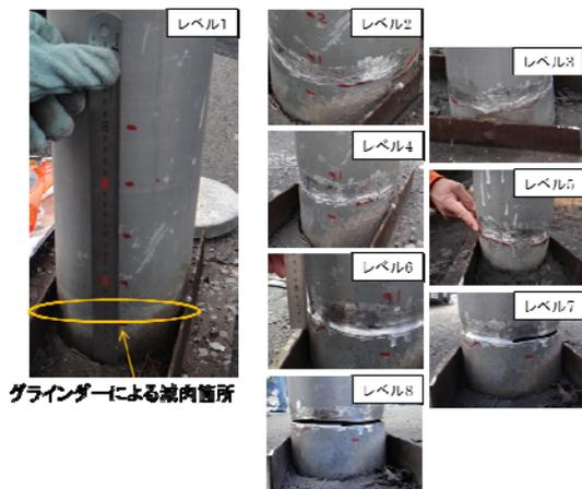
図 2 ガードレール支柱腐食劣化模擬試験体の外観
