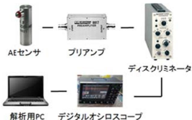
図 1 AE センサを用いた打音検査システムの構成
