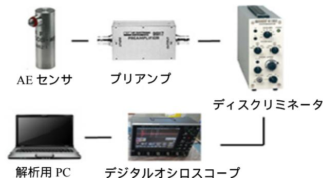
図2 AE センサを用いた打音検査システム構成
