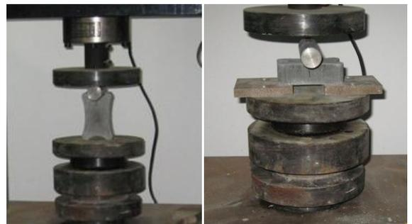
写真-1 載荷試験の状況(左:圧縮、右:曲げ)
