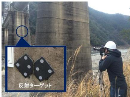
図-1 反射ターゲットと計測の様子
