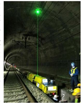
図3 トンネル中央通路走行型の装置
