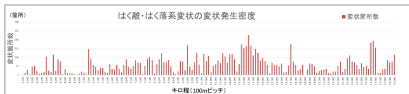
図-2 変状発生密度分布図（はく離・はく落系変状）
