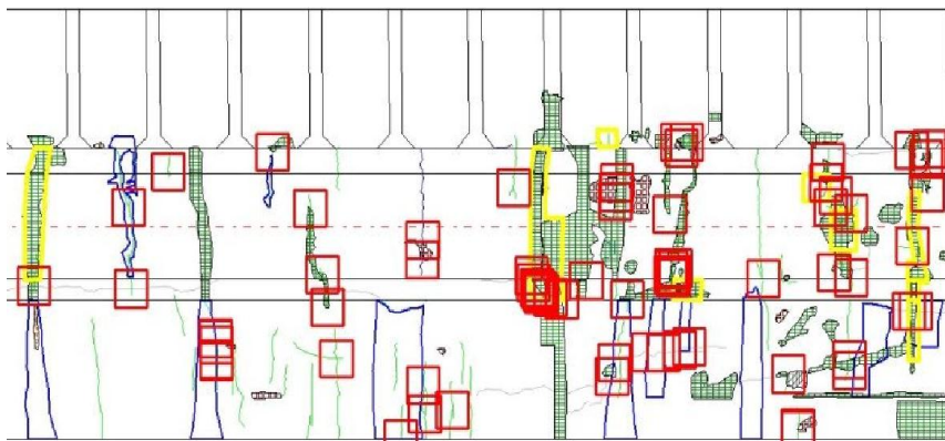
図-3 はく離・はく落の変状パターン (打音検査結果→黄色, 自動抽出結果→赤色)
