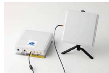
写真3 近接無線による外部計測器とアンテナの外観
