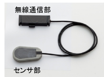
写真2 RFIDを用いた腐食環境センサ
