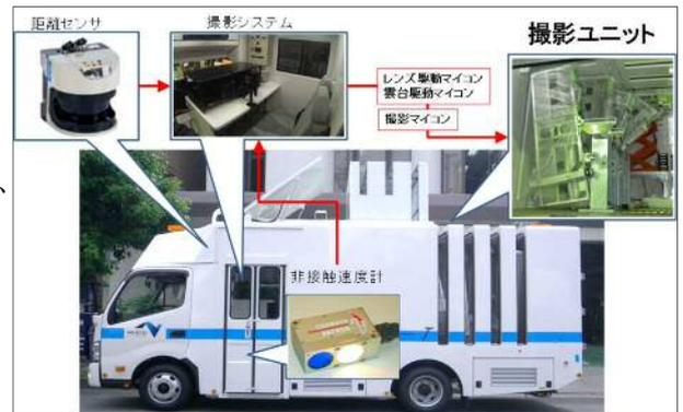
図-4 新型トンネル覆工撮影車両
