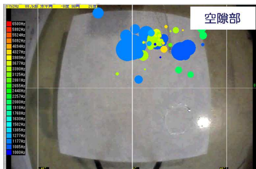
図-5 空隙部を加振した際の表示画面(例)
