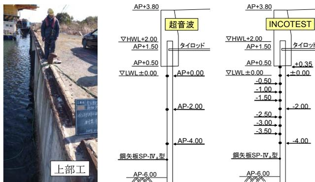
図-2 鋼矢板岸壁の構造と肉厚測定箇所
