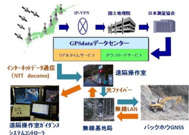
図-5 本件 VRS 方式ガイダンスシステム図
