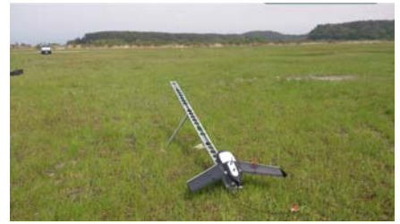
図-4 GPS搭載自律飛行測量機
