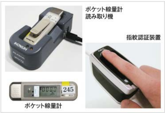
図-3 ポケット線量計と読み取り機 指紋認証装置
