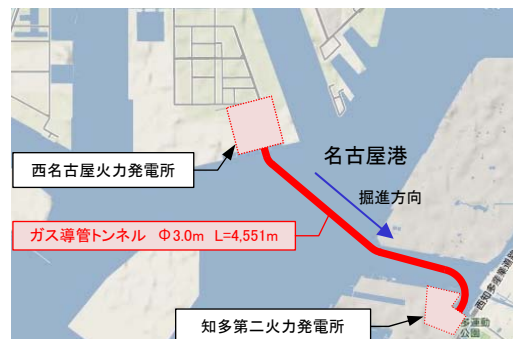
図-1 トンネル平面線形
