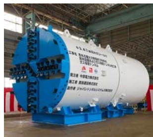
写真-1 シールド機全景
