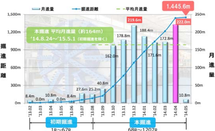
図-5 西谷トンネル掘進進捗図
