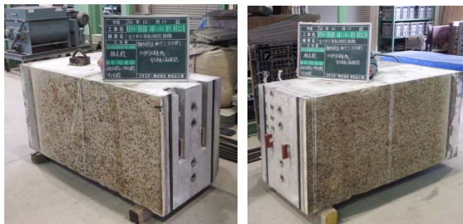
写真-4 継手部加熱後（正曲げ）
