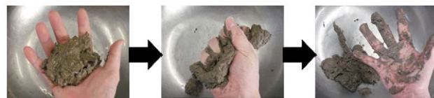
写真-1 手触りによる評価方法
