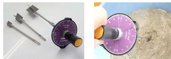
写真-3 ベーンせん断試験による評価方法
