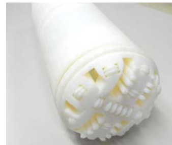
写真-1 シールド機の模型
