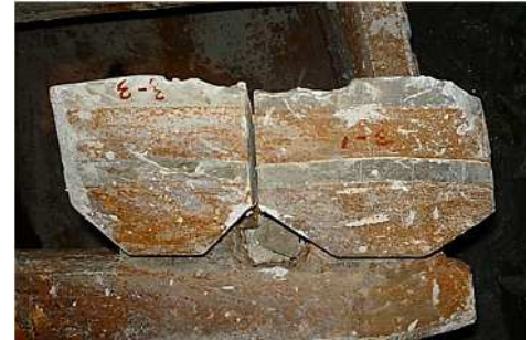
図-1 ビット破損の一例
