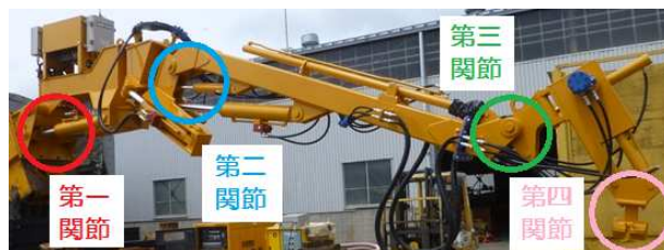
図－２ ロボットアームの関節位置
