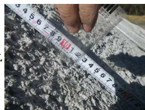
図－５ 平滑度の確認方法 写真－３ 平滑度の測定
