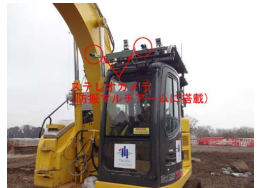
図-2 ステレオカメラを搭載した油圧ショベル (赤丸部)
