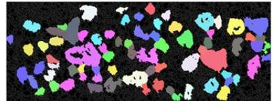
図 1 撮影画像と画像解析結果例 (粒径 40mm 以上)
