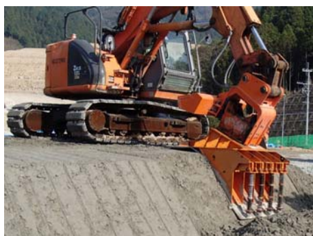
写真-1 従来の端部法面締固め機
