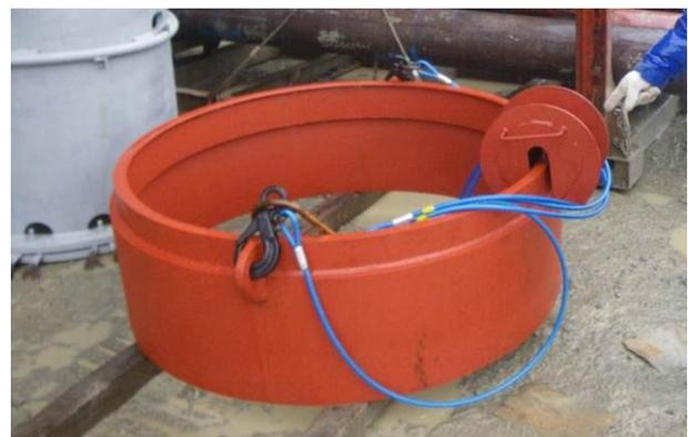
写真-3 機械式継手保護キャップ
