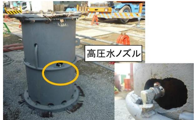
写真-1 鋼管内清掃装置
