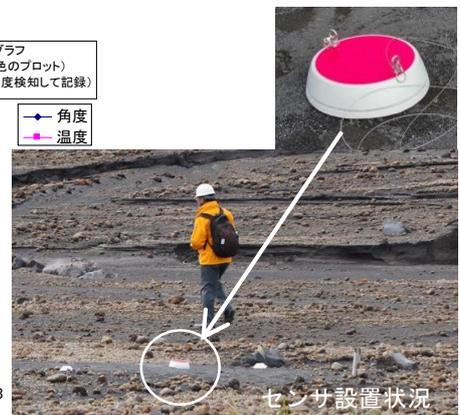
図-3 小型 UAV により中継、回収した地山動態監視無線センサデータの経時変化とセンサ設置状況
