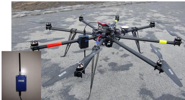
図-1 小型UAVと搭載する920MHz帯無線中継機
