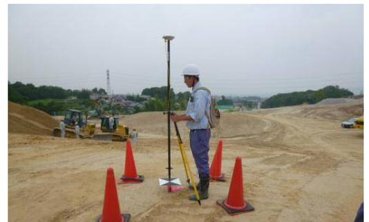
図 3 VRS-GPS による基準点測量
